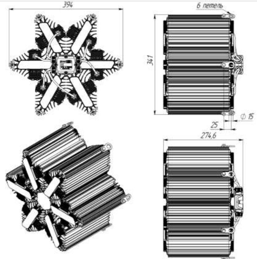
Рисунок 1 Светильник «L-lego 330». Подвесное крепление
