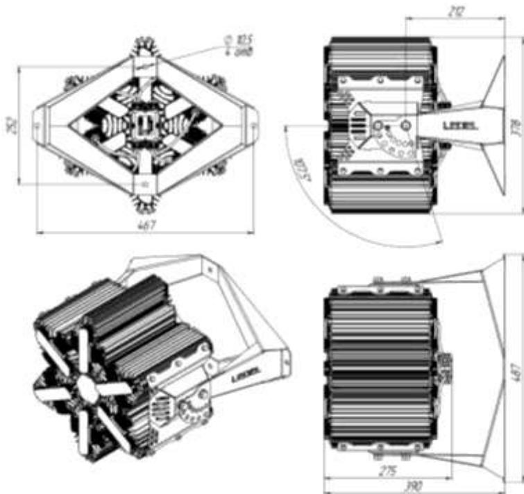
Рисунок 2 Светильник «L-lego 330 banner» Поворотное крепление
