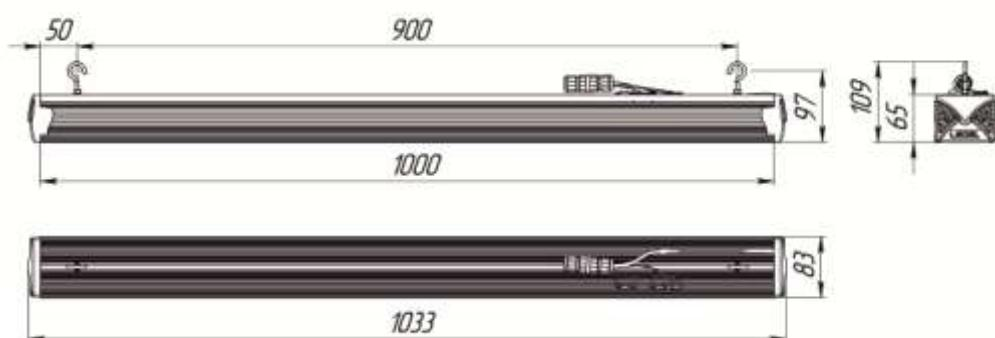
Рисунок 2 Светильник « L-industry NEW 48T». Подвесной вариант
